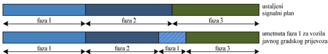
Slika 5: Grafički prikaz tehnike umetanja faze za ciljanu skupinu vozila [6]
