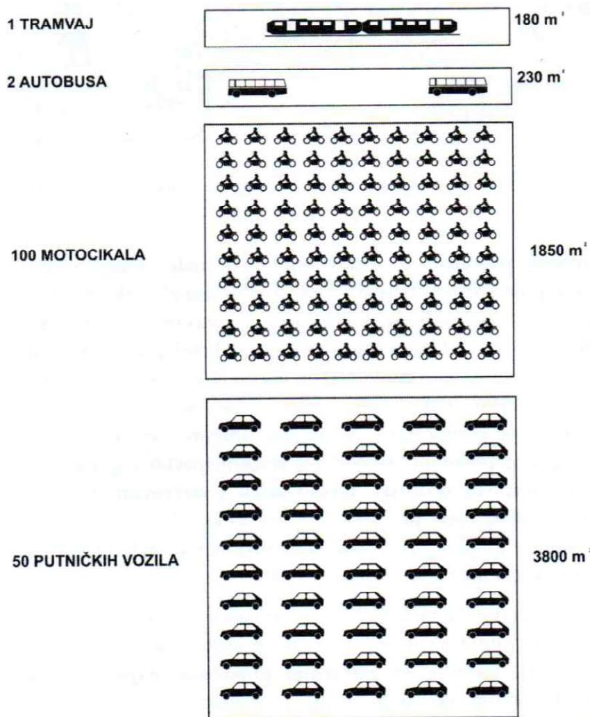
Slika 1: Usporedba prostora prema vrstama cestovnih vozila [5]
