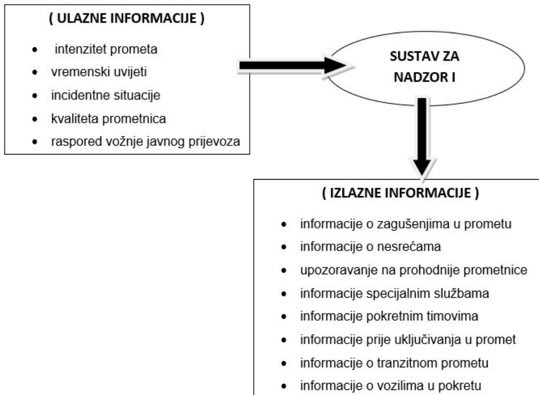
Slika 23: Informacijski tokovi sustava za nadzor i upravljanje [19]
