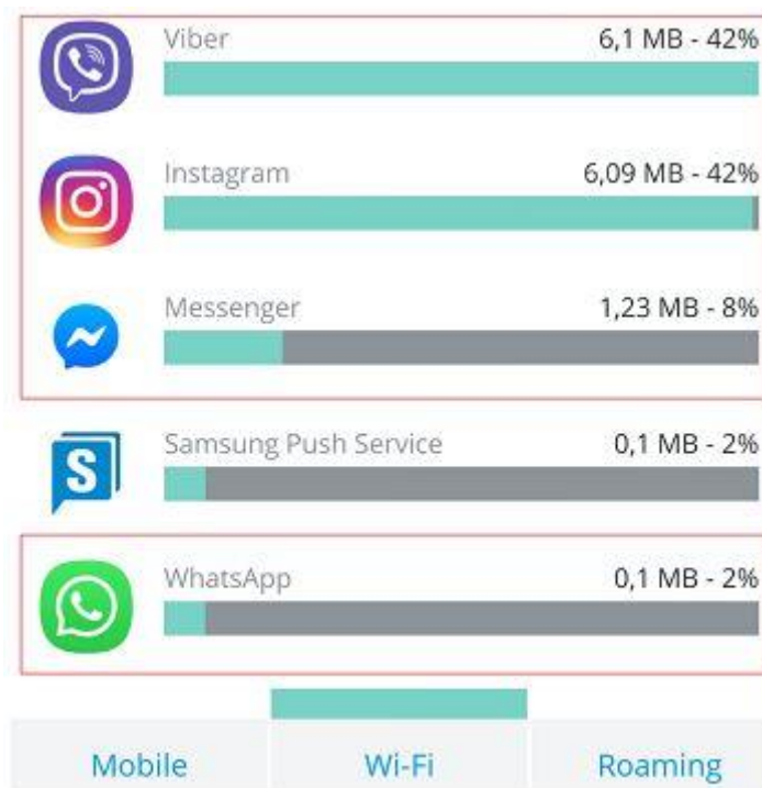
Slika 8. Generirani podatkovni promet ostvaren pregledavanjem zaprimljenog videozapisa na uređaju Samsung Galaxy S9+, Izvor: [Autor]
