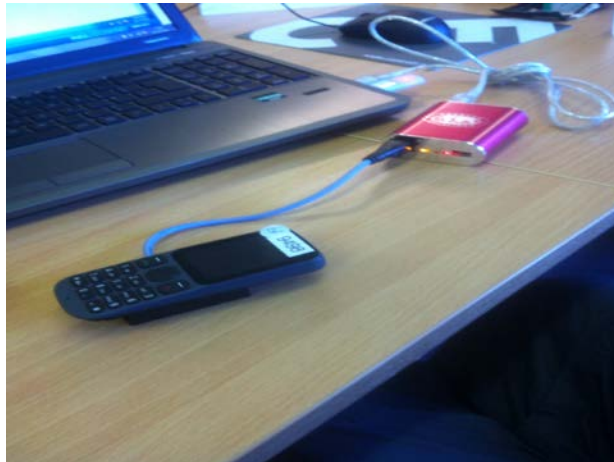
Slika 5: Prikaz ekstrakcije mobilnog uređaja korištenjem Flasher Box-a, [50]
