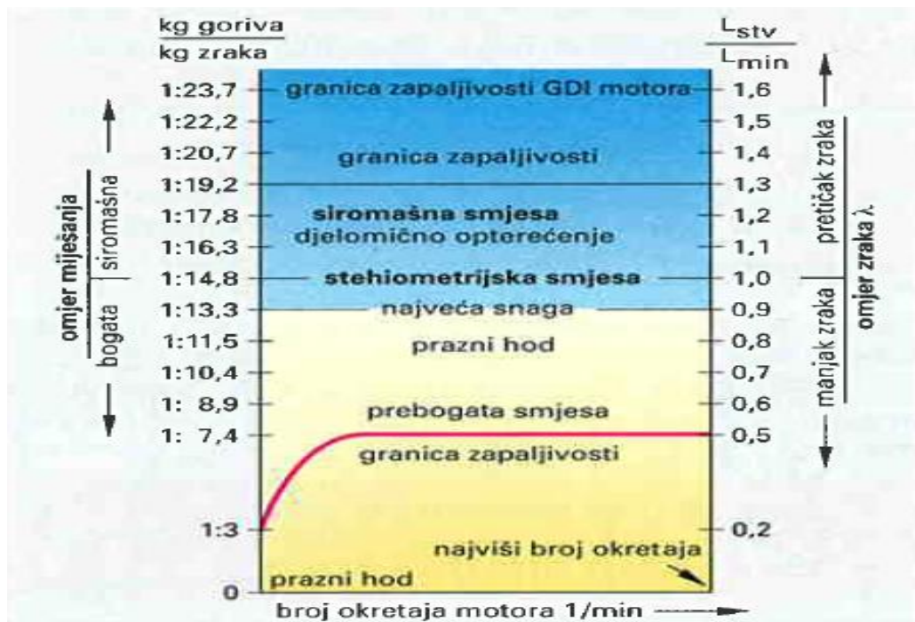
Slika 23. Omjer zraka i omjer miješanja
