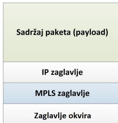
Slika 9. Struktura paketa sa MPLS zaglavljem
