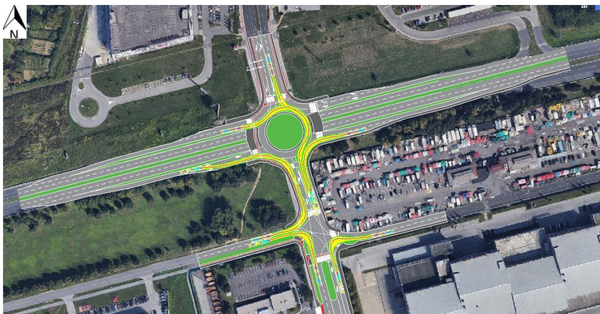
Slika 25. Prikaz mjerodavnog vozila na trećem varijantnom rješenju
