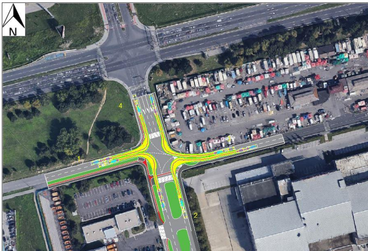
Slika 23. Prikaz proznosti mjerodavnog vozila na drugom varijantnom rješenju
