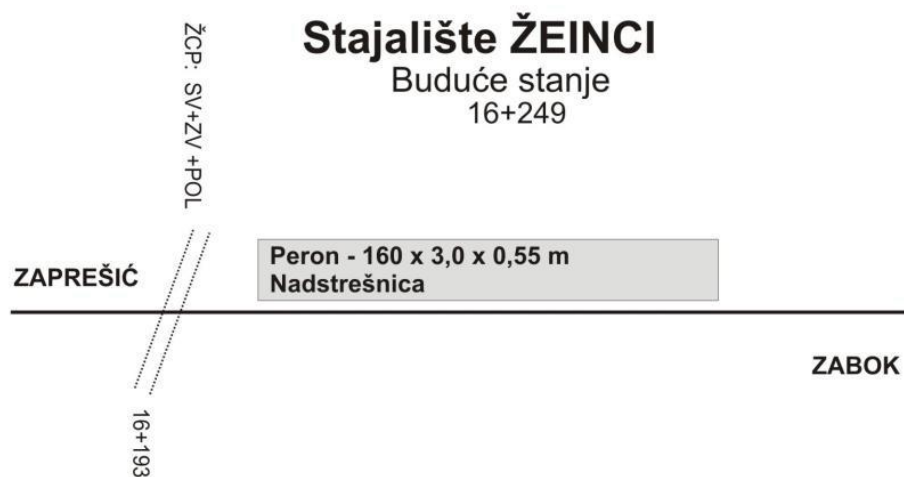
Slika 19. Shematski prikaz stajališta Žeinci nakon rekonstrukcije
