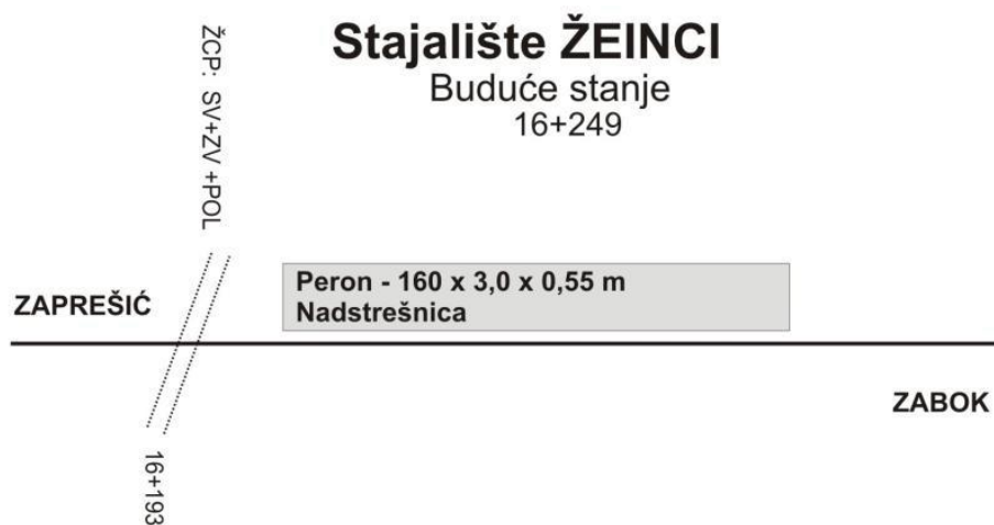
Slika 19. Shematski prikaz stajališta Žeinci nakon rekonstrukcije
