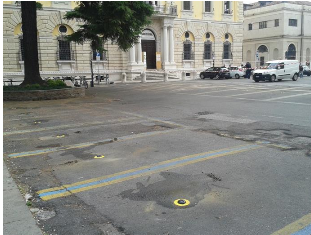
Slika 3-2. Parkirališni senzori na Piazza Viviani Izvor: [16]
