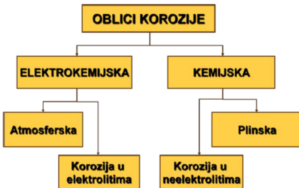
Slika 8. Oblici korozije ovisno o procesu nastanka [4]
