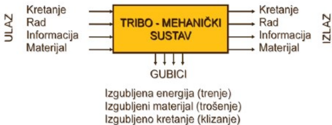
Slika 3. Shema tribomehaničkog sustava [4]
