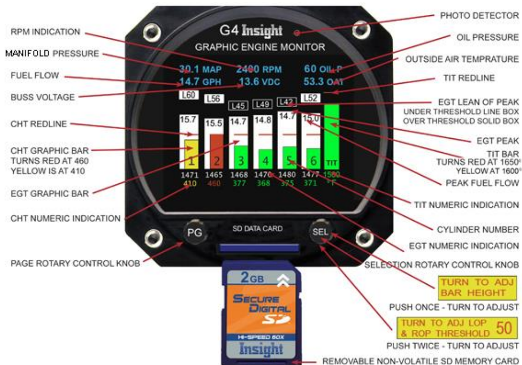
Slika 11: Prikaznik i dijelovi uređaja Insight G4 [15]
