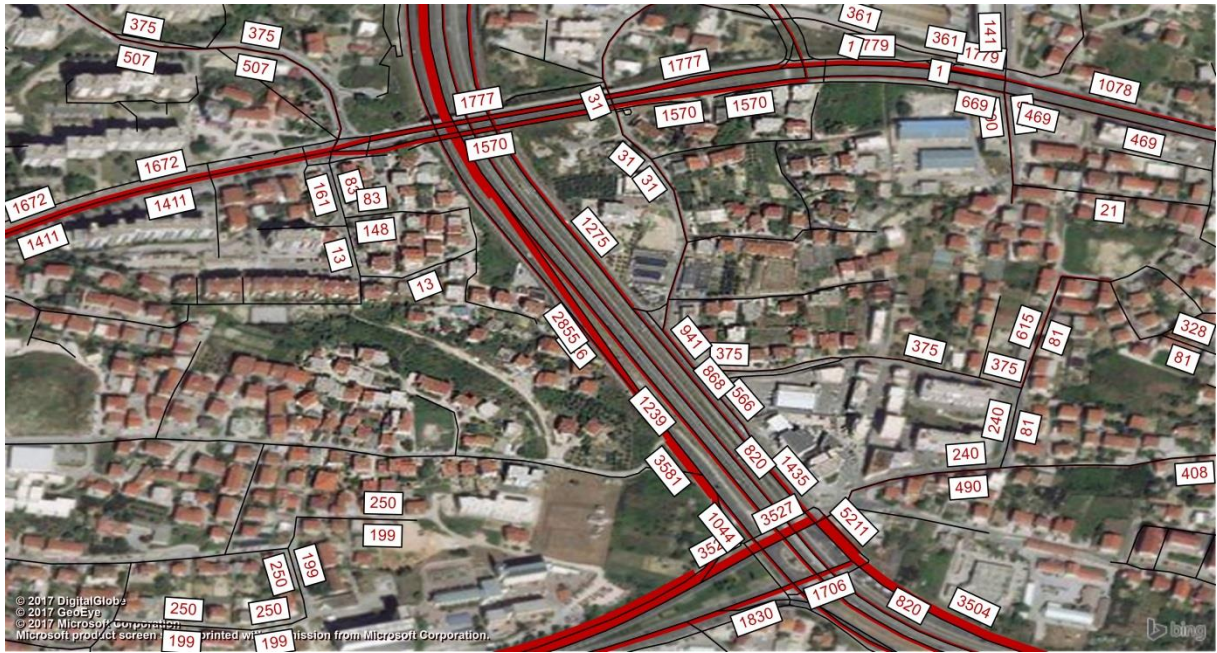
Slika 51. Model prometnih tokova uslijed izgradnje prijelazne rampe
