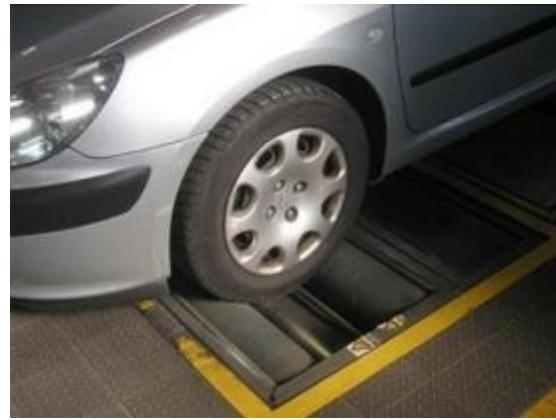
Slika 12. Mjerenje kočne sile [14]
