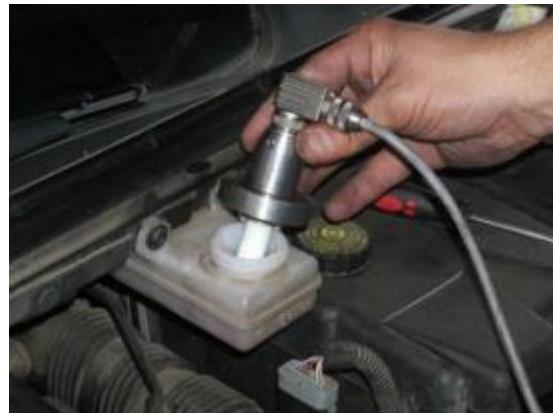
Slika 9. Mjerenje točke isparavanja kočne tekućine [14]
