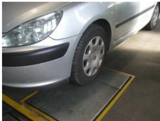
Slika 10. Ispitivanje usmjerjenosti traga kotača [14]
