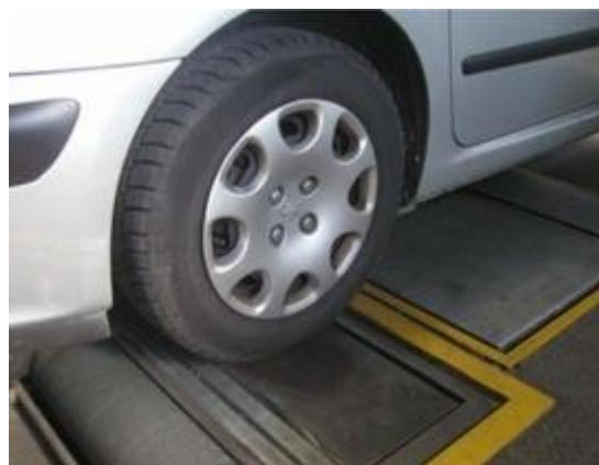
Slika 11. Ispitivanje stupnja prigušenja amortizera [14]
