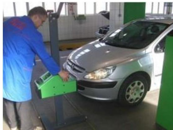
Slika 13. Ispitivanje visine svjetlosnog snopa [14]
