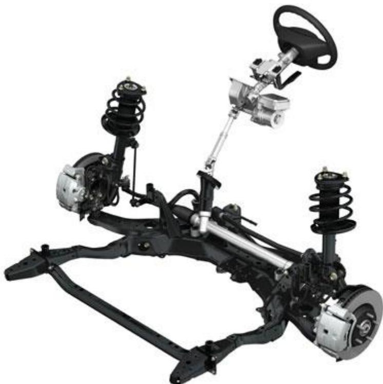
Slika 4. Prikaz upravljačkog mehanizma [11]
