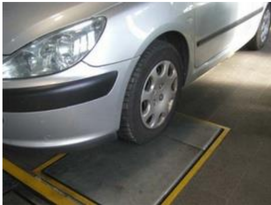
Slika 10. Ispitivanje usmjerenosti traga kotača [14]
