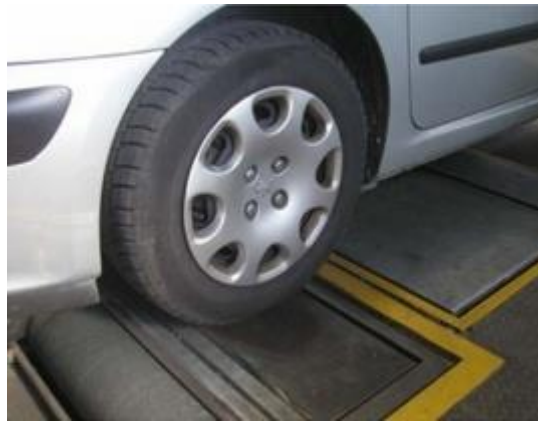
Slika 11. Ispitivanje stupnja prigušenja amortizera [14]
