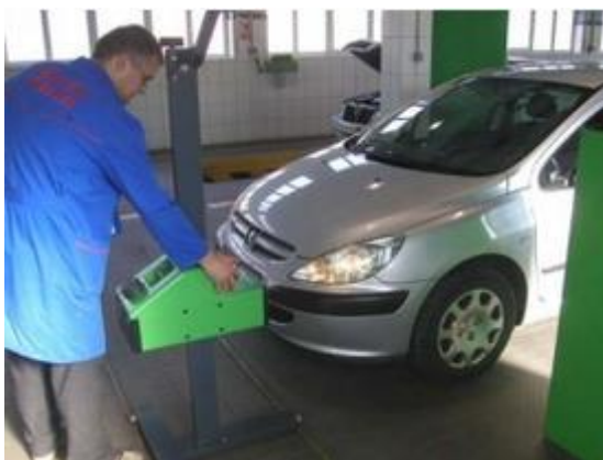
Slika 13. Ispitivanje visine svjetlosnog snopa [14]
