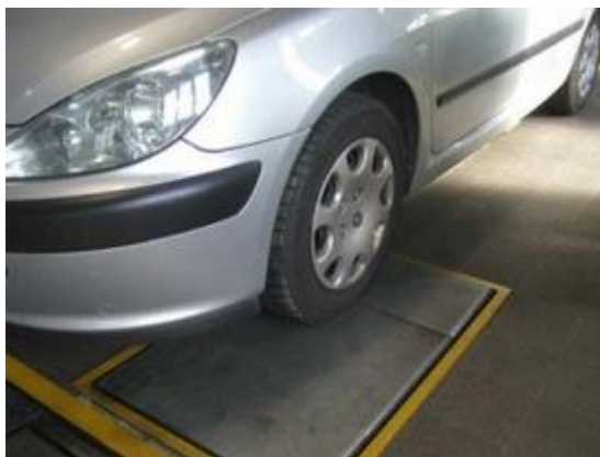
Slika 10. Ispitivanje usmjerenosti traga kotača [14]
