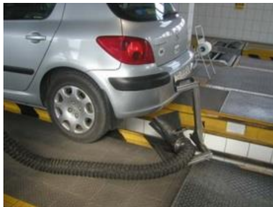
Slika 8. Ispitivanje ispušnih plinova [14]
