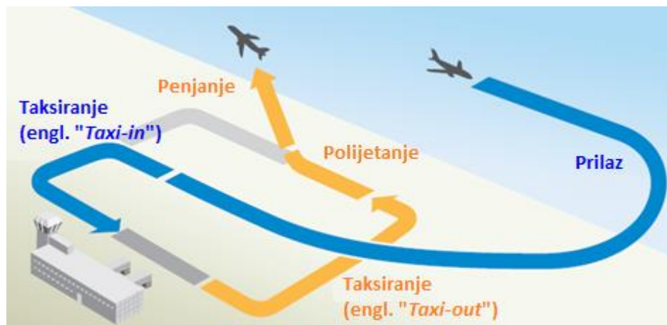
Slika 4. Ciklus polijetanja i slijetanja (engl. Landing and Take Off )
