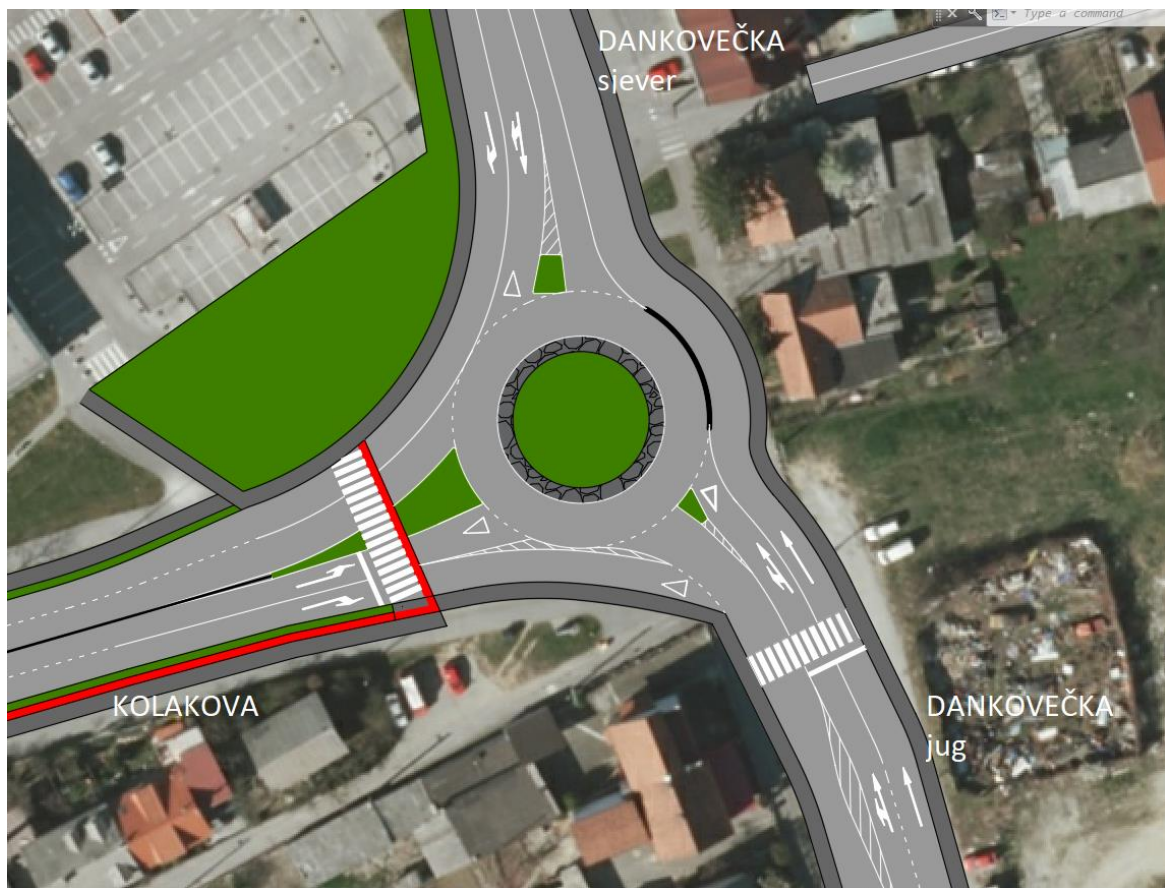
Slika 21. Idejno rješenje RKT Dankovečka – Kolakova
