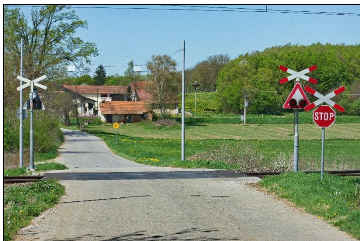
Slika 11. Željezničko-cestovni prijelaz osiguran svjetlosnim i zvučnim signalima
