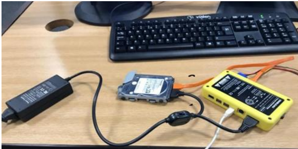
Slika 15: Postupak povezivanja Tableau T35e blokatora s tvrdim diskom PS -a
