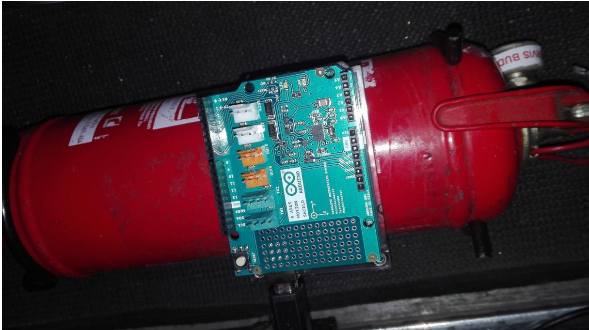
Slika 22.: Smještaj akcelerometra u zrakoplov
