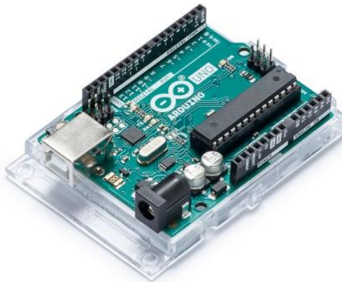
Slika 12.: Arduino Uno Rev3 mikrokontroler
