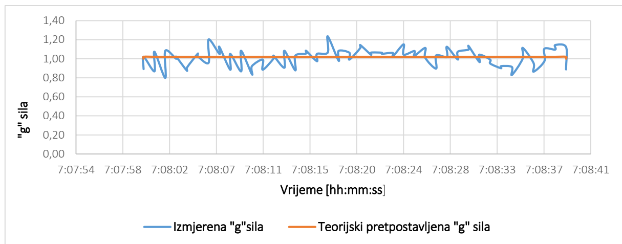
Graf 1.: Lijevi zaokret nagiba 10° pri brzini od 90 kts
