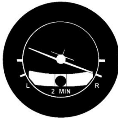
Slika 9.: Desni koordinirani zaokret sa kuglicom inklinometra u sredini
