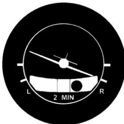
Slika 10.: Zrakoplov u desnom nekoordiniranom zaokretu („Slipping turn“)
