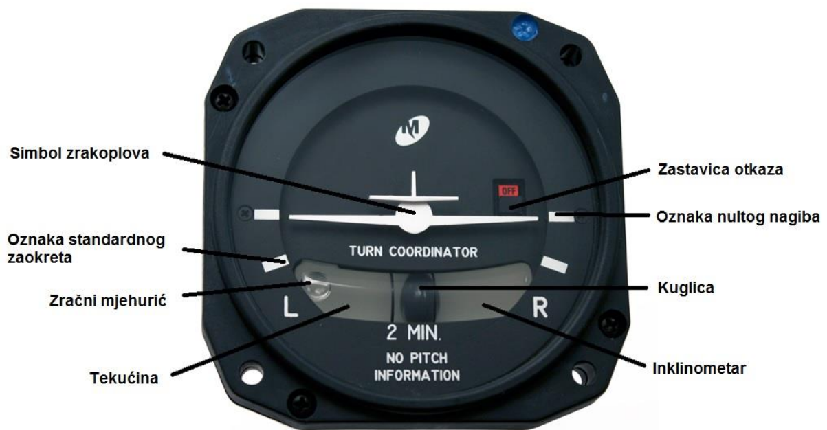
Slika 8.: Indikator skretanja i klizanja sa pripadajućim inklinometrom
