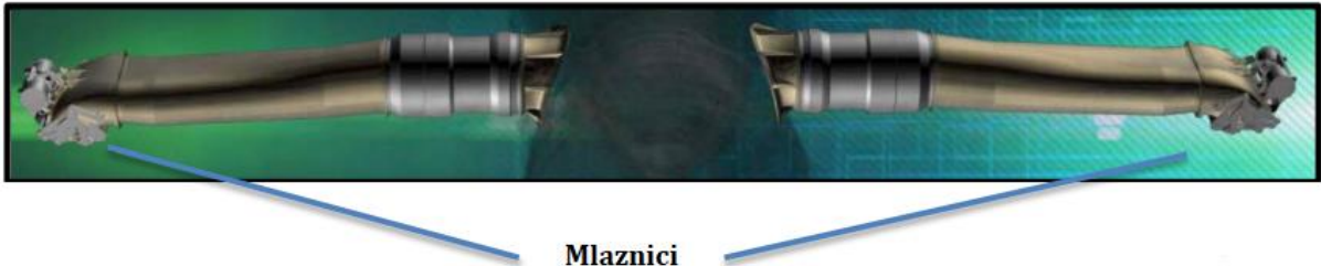
Slika 28 - Postave za rotaciju STOVL motora [10]
