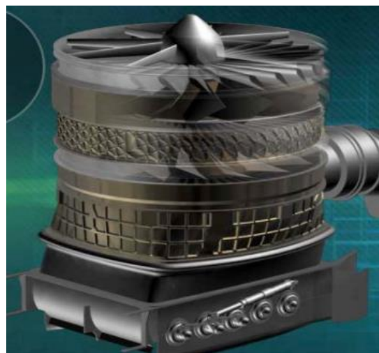
Slika 27 - Fan za uzgon STOVL motora [10]
