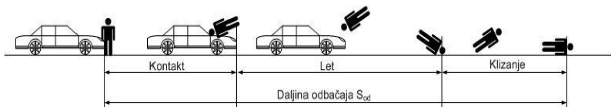
Slika 6. Faze frontalnog naleta[3]
