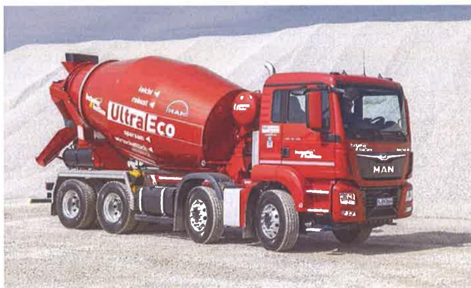
**Slika 6. Automješalica za prijevoz betona**
