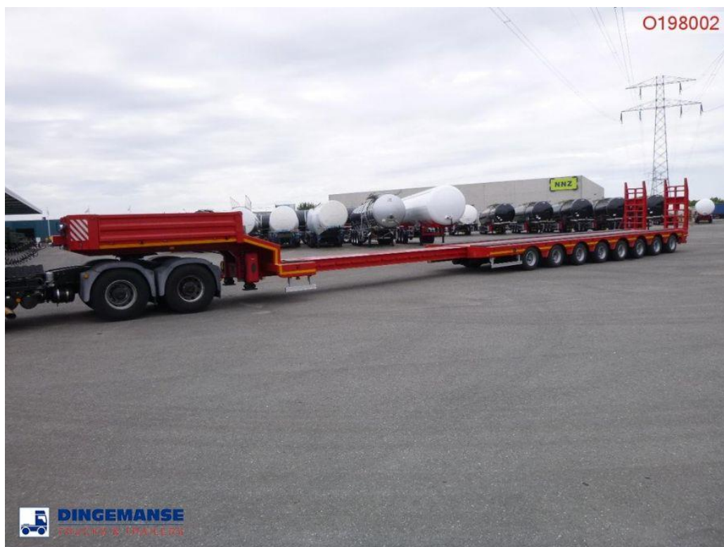
Slika 8: Niskopodna poluprikolica marke Gurlesenyil s 8 osovina
