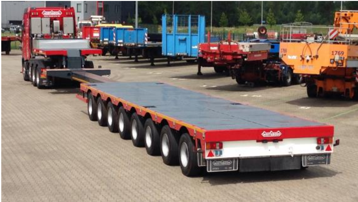
Slika 9: Niskopodna osmerosovinska poluprikolica marke Nootboom MCO-121-08V
