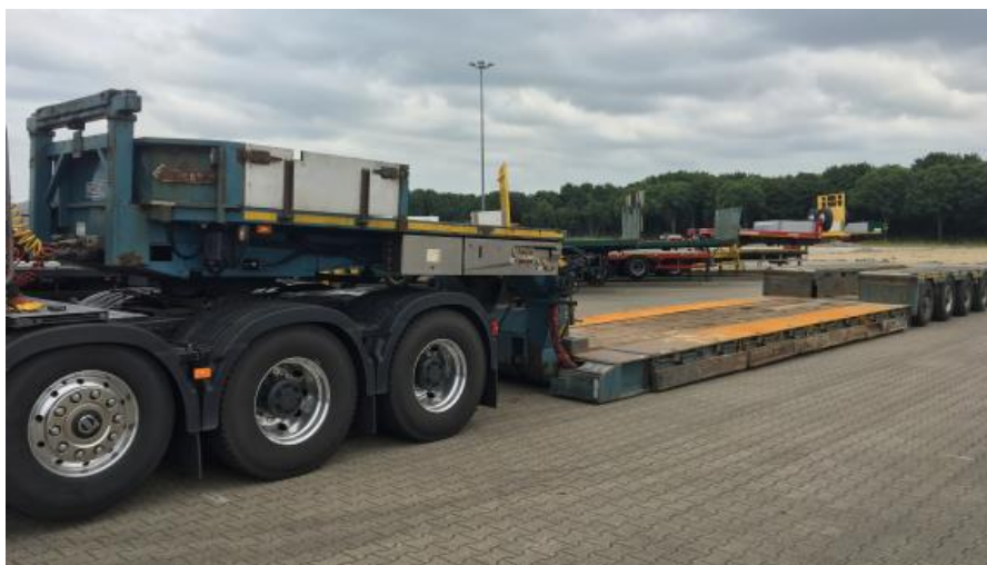
Slika 12: Trodijelna niskopodna četverosovinska poluprikolica marke Nootboom EURO-96-04 (P)
