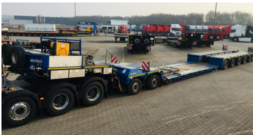
Slika 10: Trodijelna niskopodna sedmeroosovinska poluprikolica marke Nootboom EURO-107-25 (ICP)
