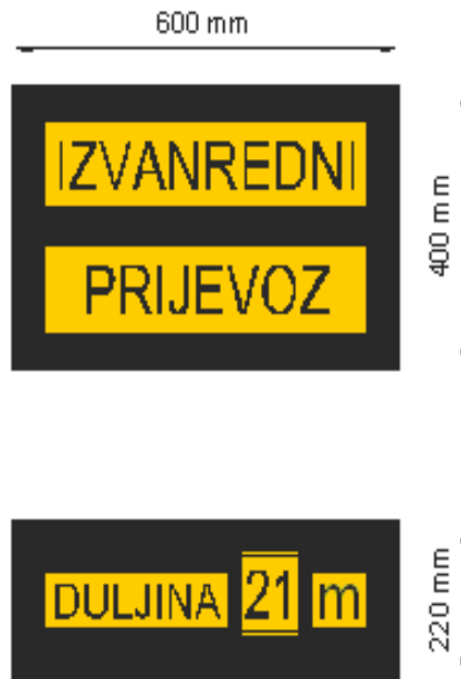
Slika 3: Skica oznake "Izvanredni prijevoz" i dodatne oznake "Duljina 21m"
