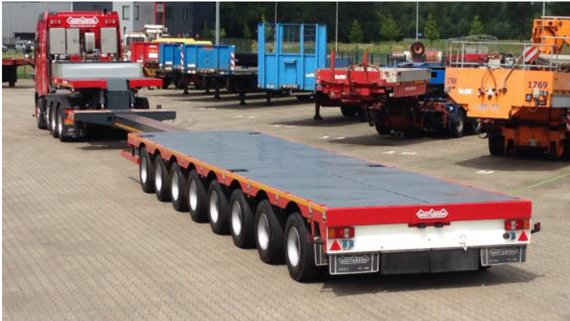
Slika 9: Niskopodna osmerosovinska poluprikolica marke Nootboom MCO-121-08V
