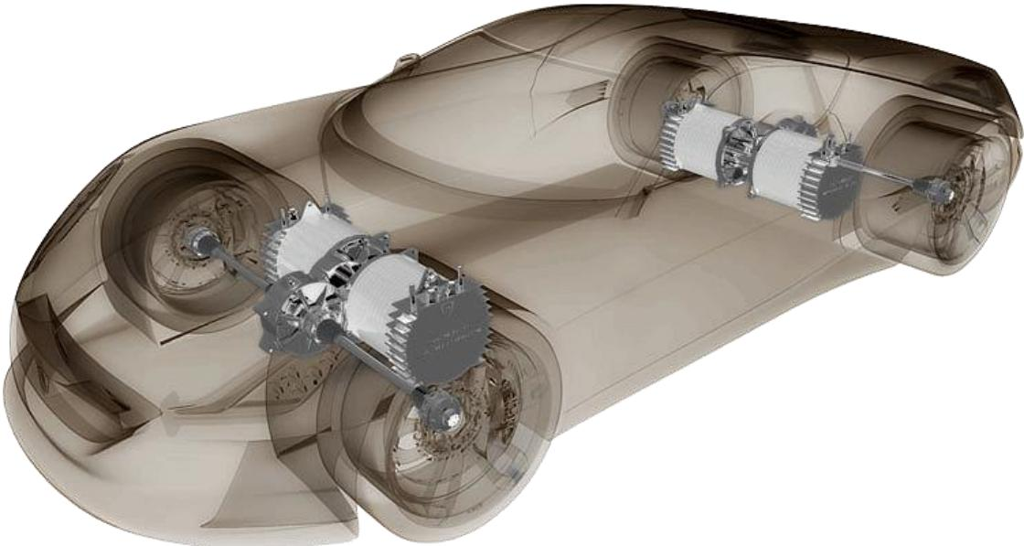
Slika 6. Električno vozilo s 4 istosmjerna motora
