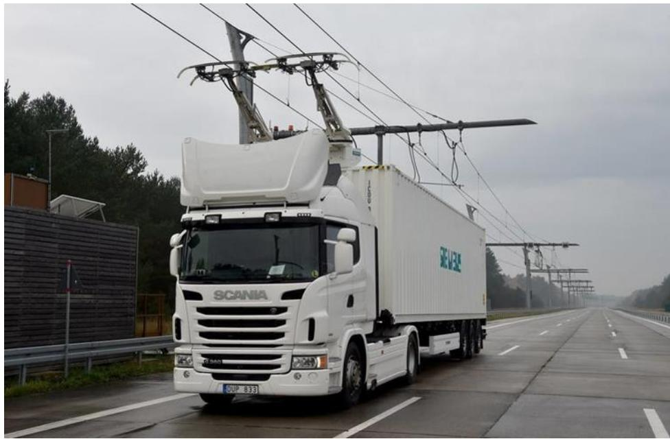
Slika 10. Hibridni kamion s pantografom tvrtke Scania
