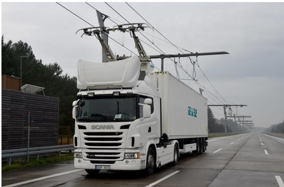
Slika 10. Hibridni kamion s pantografom tvrtke Scania
