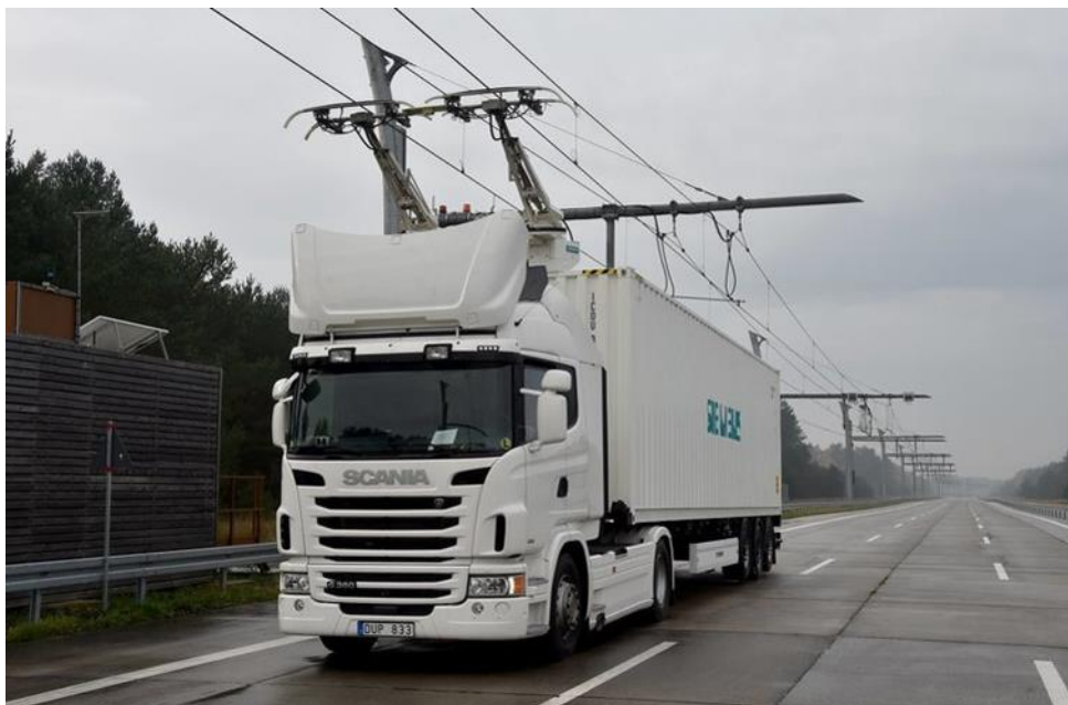
Slika 10. Hibridni kamion s pantografom tvrtke Scania
