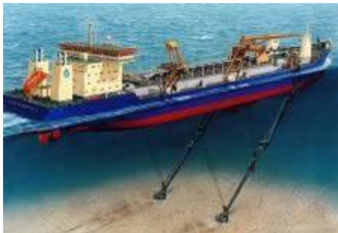
Slika 6. Jaružala koja rade na principu usisavanja
