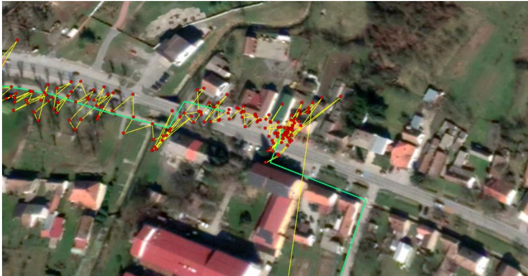
Slika 61. Početna/krajnja točka rute izmjerena Galileo sustavom
