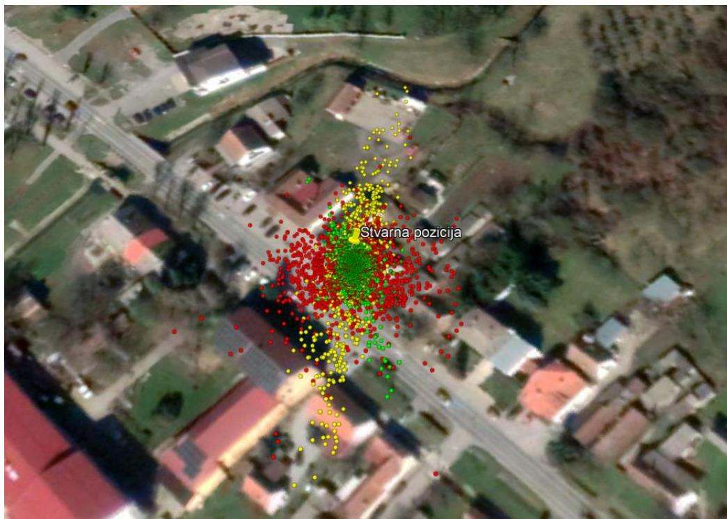
Slika 38. Usporedba GPS, GLONASS i Galileo sustava
