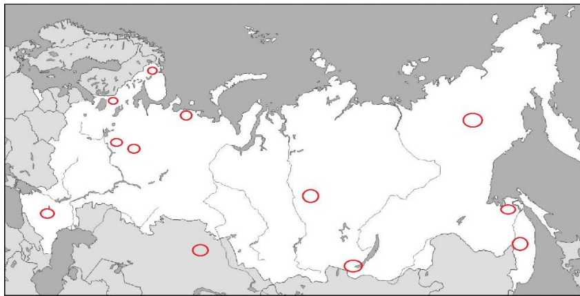
Slika 6. GLONASS Zemaljski segment
