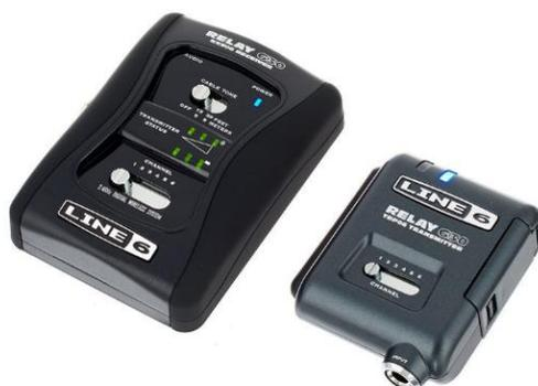
**Slika 13.** Prijemnik i predajnik bežičnog mikrofonskog sustava, [23].
