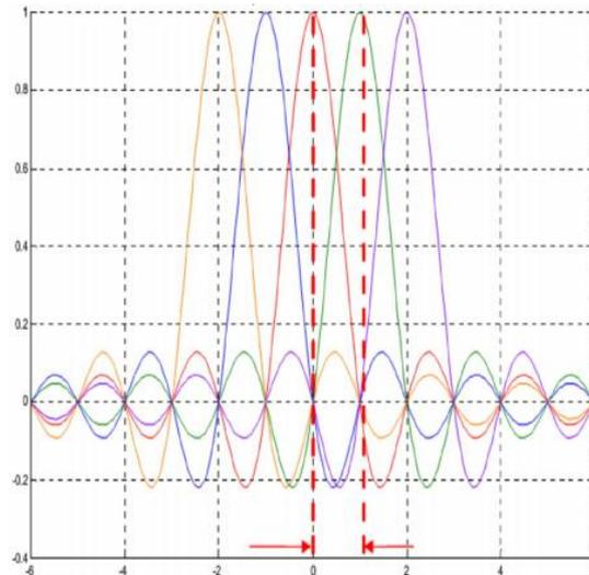
**Slika 4.** Prikaz OFDM valova podnosioca u frekvencijskom spektru, [5].
