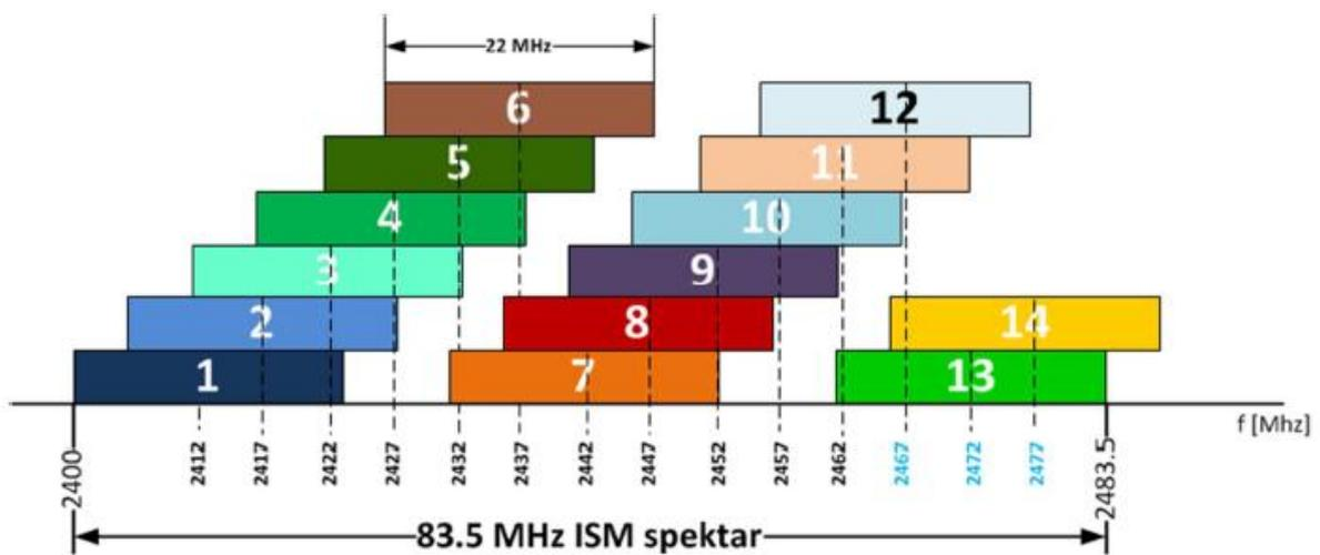
Slika 6. Raspored kanala u 2,4 GHz pojasu, [15].
