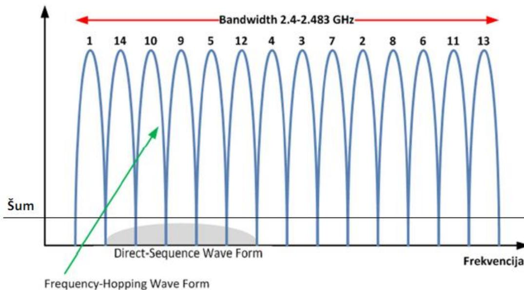
**Slika 3.** Princip rada FHSS i DSSS, [4].
