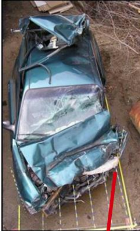
Slika 2. Princip smjera djelovanja sile uz pomoć Superman tehnike
