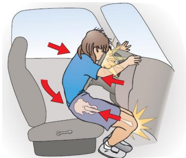
Slika 9. Tijelo u trenutku kontakta se kreće prema naprijed i u smjeru dolje
