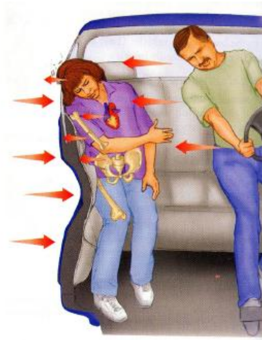
Slika 20. Sile djelovanja na vozilo i putnike uslijed bočnog sudara
