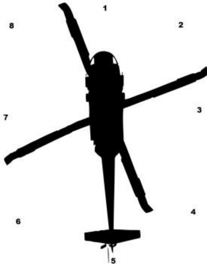
Slika 14: Mjerne pozicije za mjerenje vanjske buke, Izvor: http://clipart-library.com/clipart/kiKRkKaij.htm
