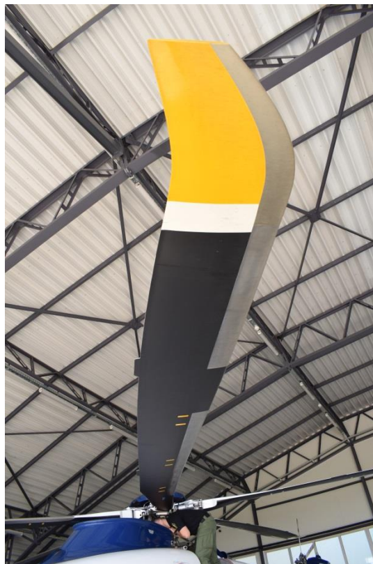
Slika 10: Parabolični vrh lopatice glavnog rotora na AW139, Izvor: Autor
