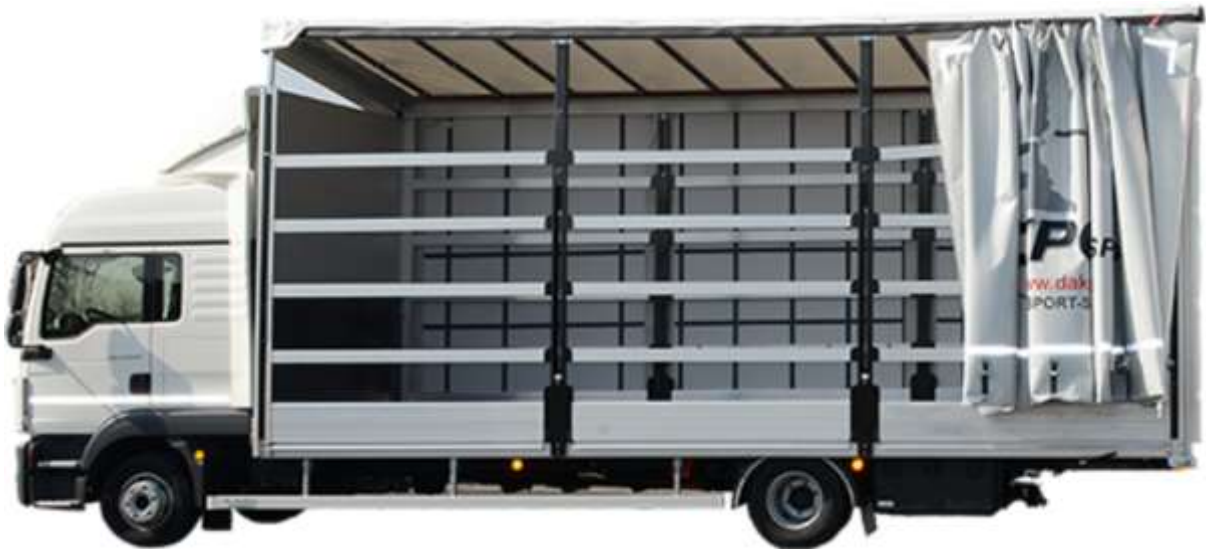
Slika 8. Kamion s Tarpaulin konstrukcijom teretnog prostora, izvor: [13]
