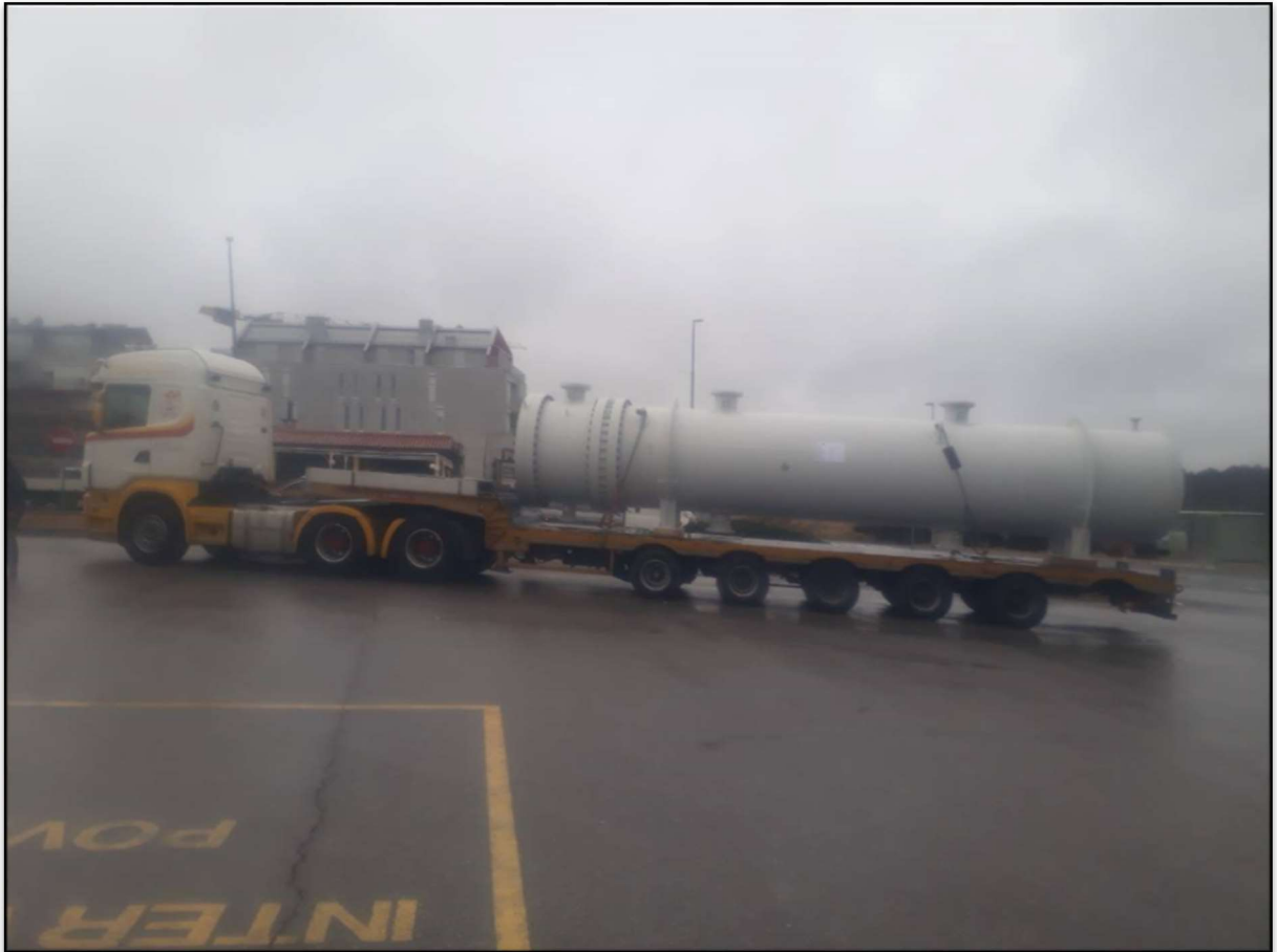
Slika 23 - Teret: Kolona za rafineriju [15]
