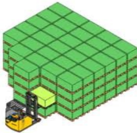
Slika 8. Način podnog skladištenja - blokovi
