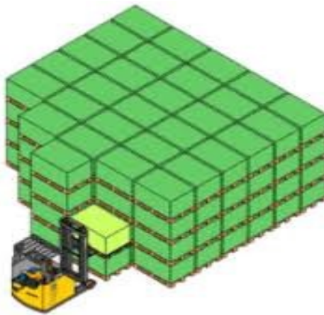
Slika 8. Način podnog skladištenja - blokovi
