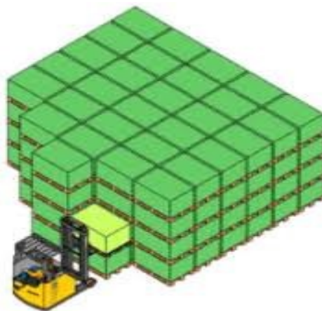
Slika 8. Način podnog skladištenja - blokovi
