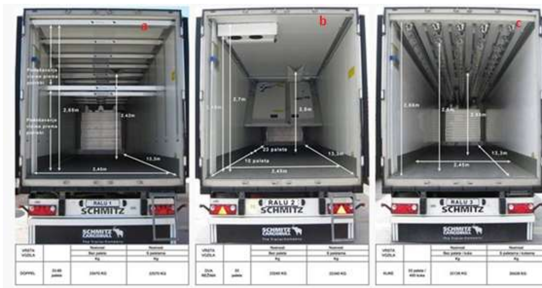
Slika 5. Vrste prikolica a) sa duplim podom za prijevoz 33-66 paleta, b) dvorežimski-za prijevoz dobara na različitim temperaturama, c) sa kukama za prijevoz mesa, Izvor www.ralu.hr
