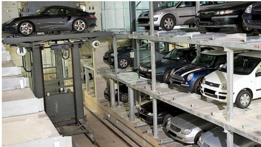
Slika 24. Pomična platforma po horizontalnoj i vertikalnoj osi; [12]
