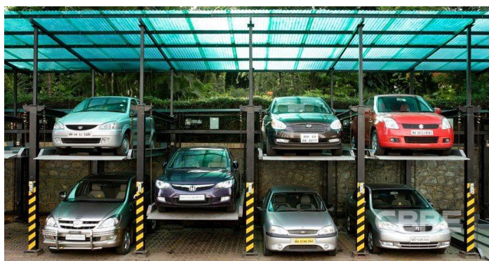
Slika 19. Djelomično mehanizirana garaža na dvije etaže; [7]
