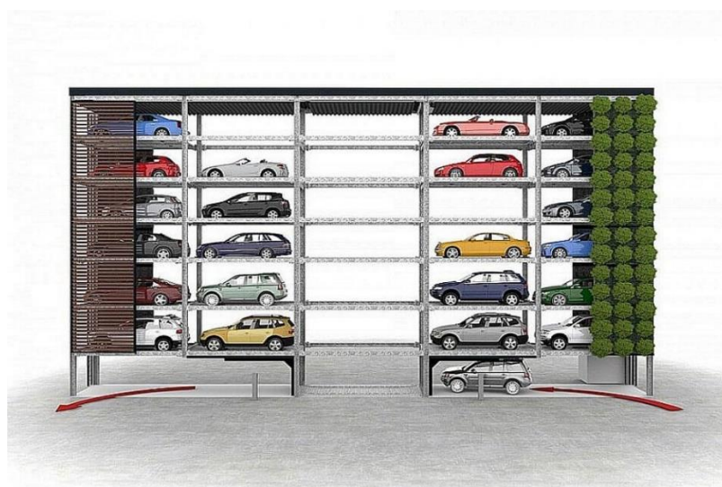
Slika 20. Djelomično mehanizirana garaža s dizalom; [8]
