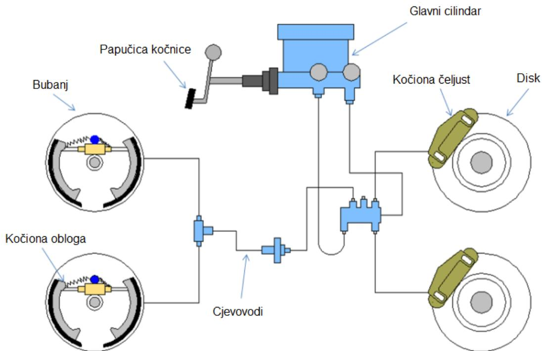
*Slika 7. Hidraulični mehanizam*
