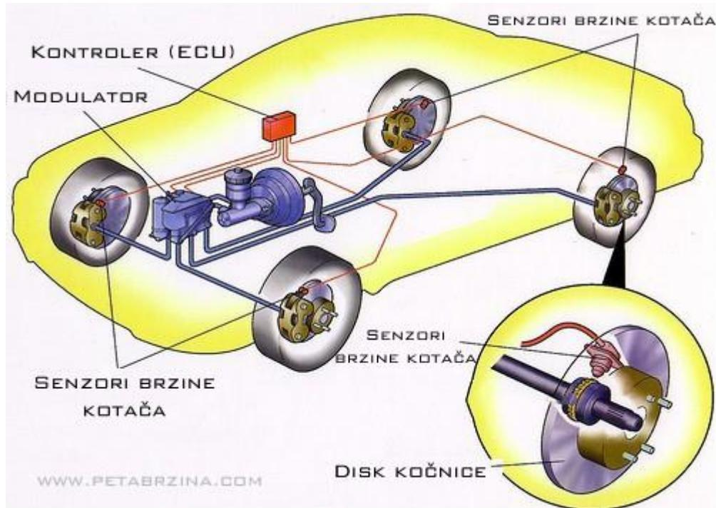
*Slika 12. Princip rada ABS-sustava*
