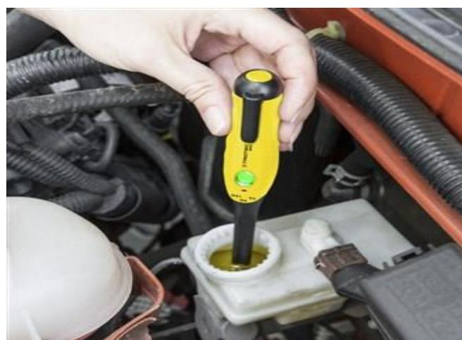
*Slika 25. Uredaj za ispitivanje kočione tekućine*
