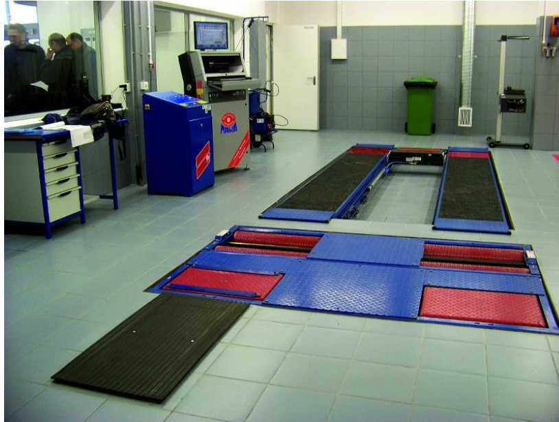
Slika 22. Valjci za kontrolu kočnica u servisnoj radionici
