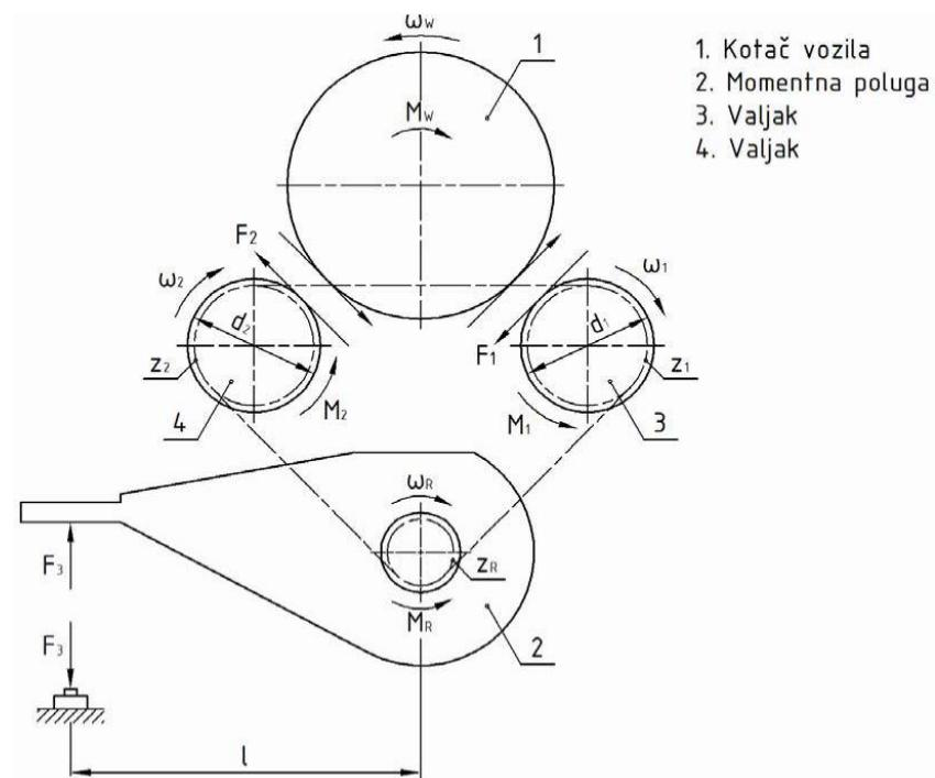
*Slika 23. Sile raspoređene na valjku uređaja za mjerjenje kočione sile*
