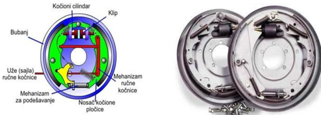
Slika 2. Konstrukcija bubanj kočnice
