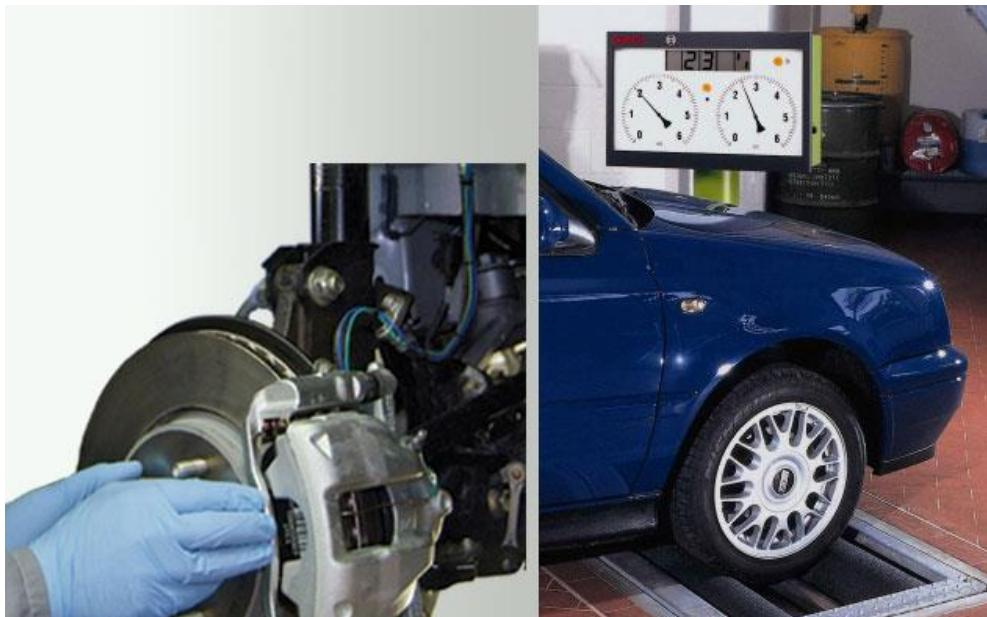
*Slika 24. Valjci s mjernim instrumentom*
