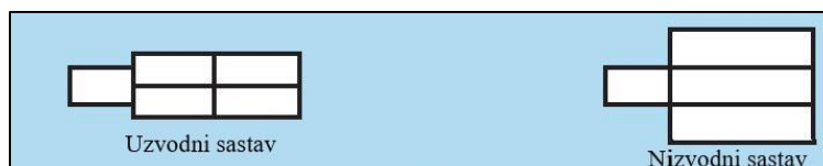
Slika 14. Uzvodni i nizvodni potiskivani sastav na podsektoru Gradiška – Slavonski Brod Izvor: [3]
