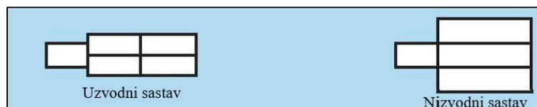
**Slika 14.** Uzvodni i nizvodni potiskivani sastav na podsektoru Gradiška – Slavonski Brod
