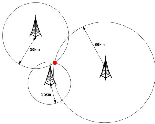
Slika 2.1. Pozicioniranje mobilnog uređaja korištenjem lateracije [4]
