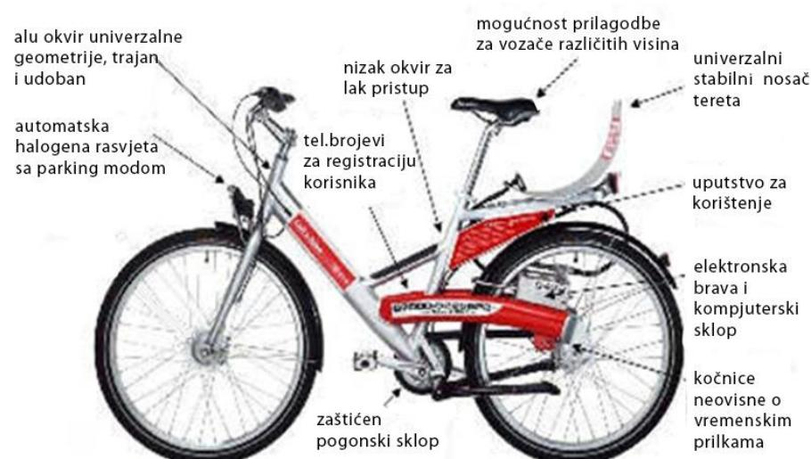
Slika 4.6. Konstrukcija javnog bicikla [34]
