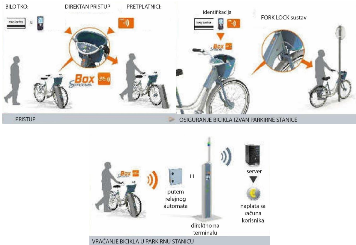
Slika 4.4. Funkcioniranje standardnog sustava javnih bicikala [34]
