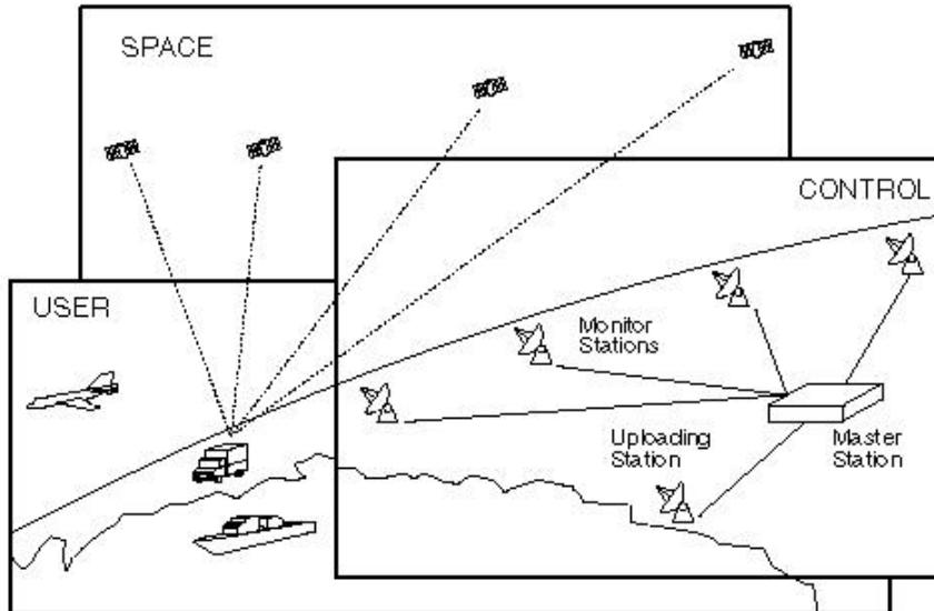
Slika 2.5. Segmenti globalnog sustava pozicioniranja [5]
