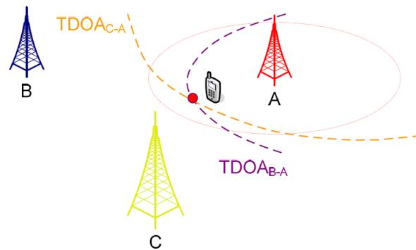
Slika 2.3. Pozicioniranje mobilnog uređaja mjeranjem razlike u vremenu dolaska signala [1]
