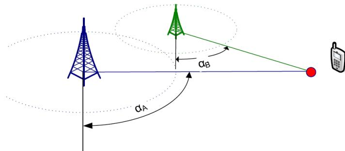
Slika 2.4. Pozicioniranje mobilnog uređaja mjeranjem kuta dolaska signala [1]
