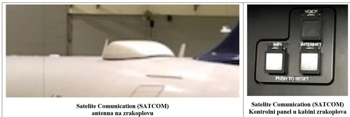
**Slika 16.** SATCOM sustav na zrakoplovu
